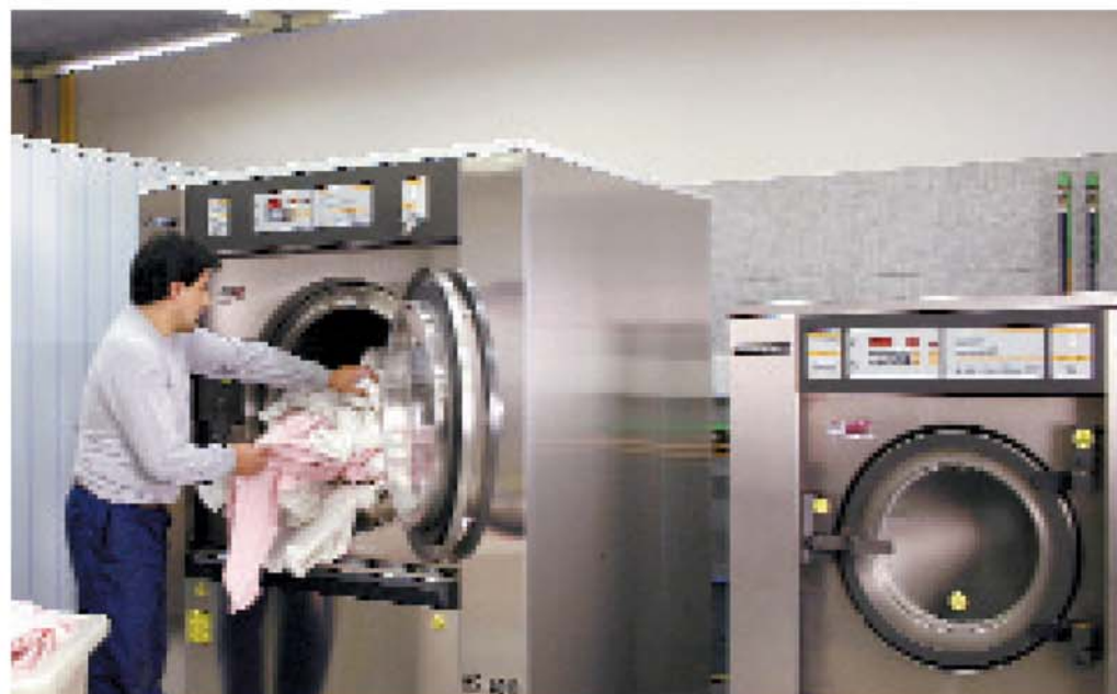
La zona de lavado se ha equipado con una lavadora de 22 kg, un una de 40 kg de capacidad respectivamente.
