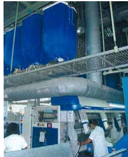
La falta de espacio en longitud y altura han decantado la elección hacia el introductor Galaxy.
