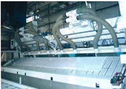
Un sistema de aspiración permite colocar la sábana encima de la mesa de introducción y aspirar la fibrina de algodón.
