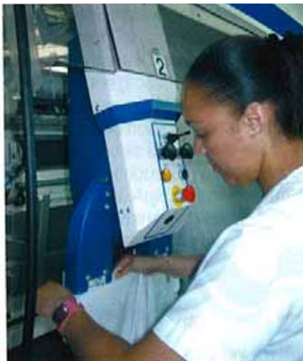
La operadora inserta la sábana en las pinzas sin buscar los bordes.
