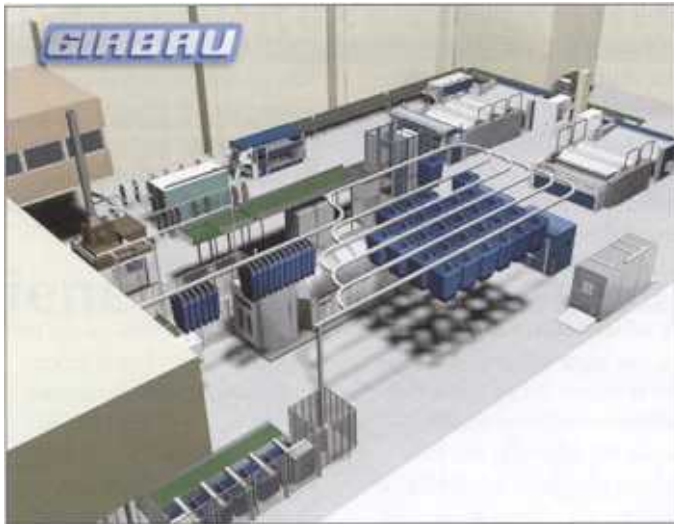
Un sistema de carga aérea transporta sacos de ropa sucia directamente al túnel de lavado.
